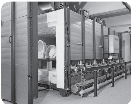
Печь периодического действия в керамической промышленности
