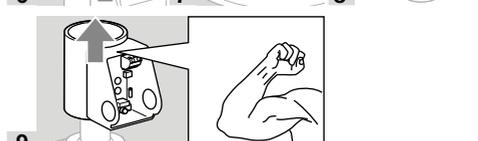
→ В зависимости от конструктивного исполнения прибора привод заменяется двумя различными способами: если у прибора на месте, указанном стрелкой, нет O-кольца, замените привод описанным здесь способом. В противном случае следуйте последующим указаниям.
